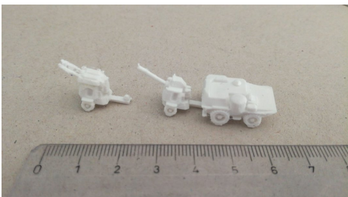
▼ Les 2 premiers tirages : impression PLA blanc en 60microns sur Ultimaker 2+.
